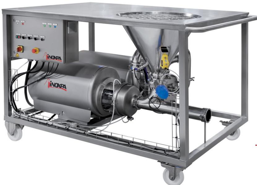
**I Especificações técnicas****Materiais:**Peças em contacto com o produto *AISI 316L (1.4404)*Outras peças de aço *AISI 304 (1.4301)*Juntas em contacto com o produto *EPDM***Fecho mecânico:**Parte rotativa *Carboneto de silício (SiC)*Parte estacionária *Carboneto de silício (SiC)*Juntas *EPDM***Acabamentos superficiais:**Interno e tremonha *Polido brilhante Ra ≤ 0,8 µm*Externo, estrutura e base superior *Mate*
